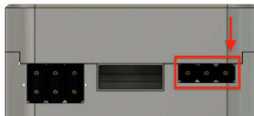
**Pour les utilisateurs de Spektrum** utiliser le connecteur ad-hoc pour relier la sortie de télémétrie du récepteur au TTU+.
