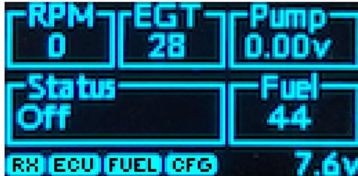
**RX** Indicateur de l'état de la communication avec le récepteur. Quand cet indicateur est allumé, il indique que le TTU+ a établi une communication avec le système de télémétrie de la radio.
