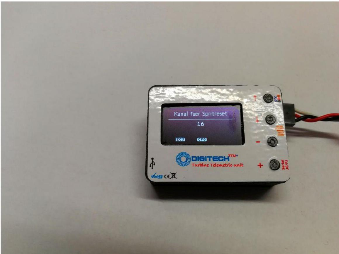
Sie können die Restfüllmenge des Tanks im laufenden Betrieb zurück setzen.
