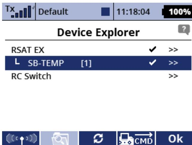
Aktivieren Sie bitte nur die Sensoreingänge im SB-TEMP, die auch mit Sensoren belegt sind. Alle anderen Eingänge bitte auf "Disabled" setzen, da ansonsten auf diesen Ports falsche Werte angezeigt werden können.
